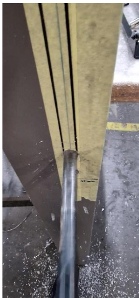
10. Verwijder de slotvanger en boor bovenaan en onderaan de slotgleuf een gat Ø14,2mm
