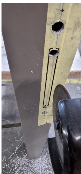
11. Zaag met een slijptol of multitool de gleuf uit.
